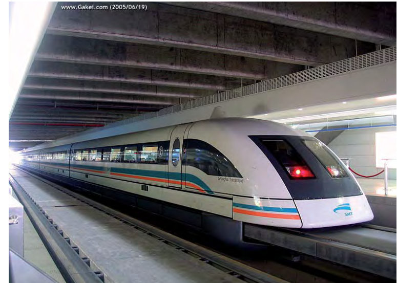
Train à lévitation magnétique reliant l'aéroport de Pudong à la ville de Shanghai (distance : 30 km) à la vitesse de 431km/h, c'est-à-dire en 8 minutes
