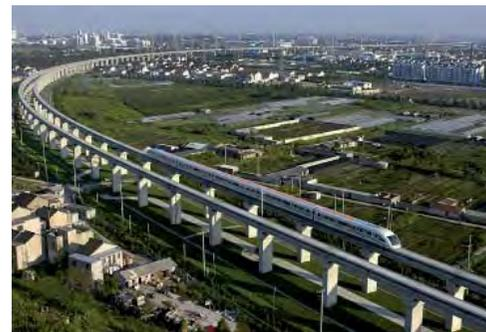
*Fig. 1. Le transrapid reliant l'aéroport de Shanghai (Pudong) à la ville atteint une vitesse de 430 km/h. Les 30 km de la ligne sont parcourus en moins de 8 minutes. Le transrapid accélère de 0 à 300 km/h sur une distance de 5 km (les trains à grande vitesse classiques ont besoin de 20 km pour atteindre la même vitesse).*
