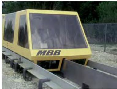
Fig. 2. Le modèle expérimental de 1972, au tout début du programme de recherche qui mènera des années plus tard au Transrapid.
