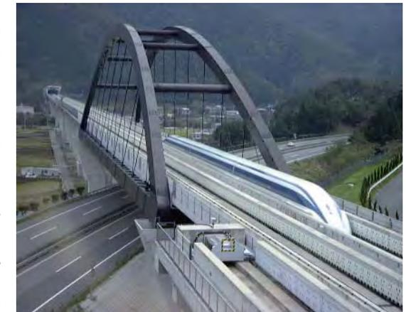
Fig. 10. Le JR-Maglev (prototype MLX01) sur la ligne d'essai de Yamanashi.
