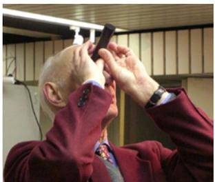
Un spectroscope portable est disponible auprès de la firme Edulab (<http://www.edulab.co.uk/cgi-bin/cp-app.cgi>) ; il est constitué d'un tube cylindrique en carton se terminant à une extrémité par une fente. A l'autre extrémité se trouve un réseau de diffraction constitué d'un mince disque en plastique portant 500 traits/mm invisibles à l'œil nu. Le spectre peut être observé par transmission avec, comme toile de fond, la paroi interne noire du tube.
