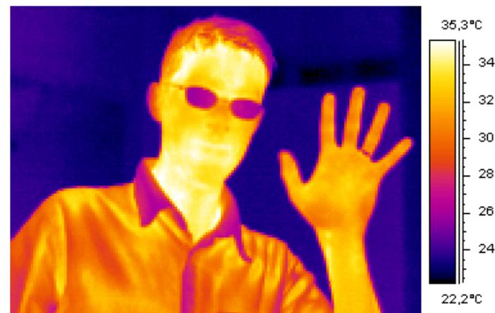
Fig. B. Image en fausses couleurs obtenue avec une caméra IR. Les parties les plus chaudes émettent une plus grande quantité d'infrarouge.
