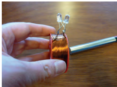
Fig. 1. Un barreau aimanté et deux LEDs (connectées anti-parallèlement à une bobine de cuivre).
