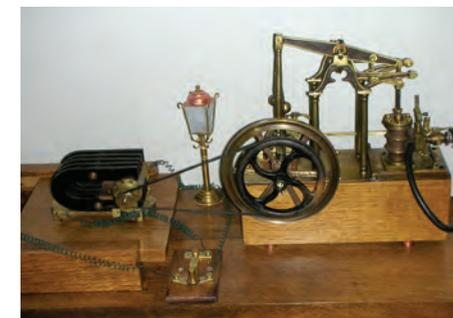
Modèle réduit d'une machine à vapeur couplée à une petite dynamo.
