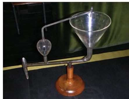
Modèle de laboratoire d'un « bélier hydraulique ».
