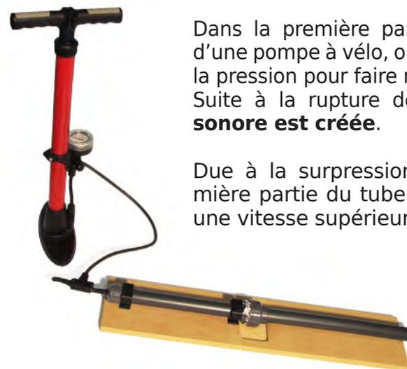
Dans la première partie du tube, à l'aide d'une pompe à vélo, on augmente fortement la pression pour faire rompre la membrane. Suite à la rupture de celle-ci, **une onde sonore est créée.**
