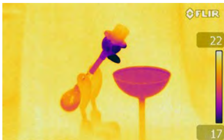
Le canard buveur photographié à l'aide d'une caméra infrarouge.
