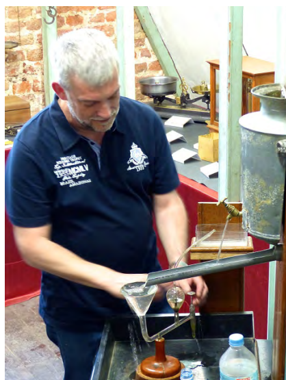
Yves Cornet fait fonctionner un bélière hydraulique (modèle de laboratoire). Ce type de pompe, installée sous la cour devant l'église, a permis aux élèves de profiter d'eau courante et douches dès 1890...
