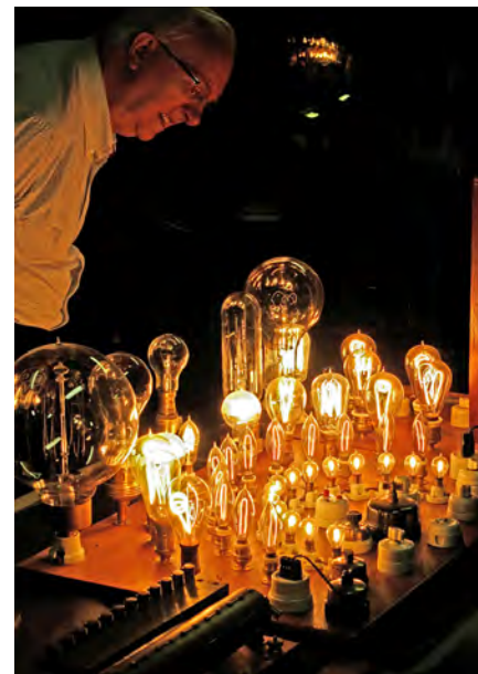
Une belle collection de lampes à incandescence à filament de carbone (type Edison) encore en état de marche.
