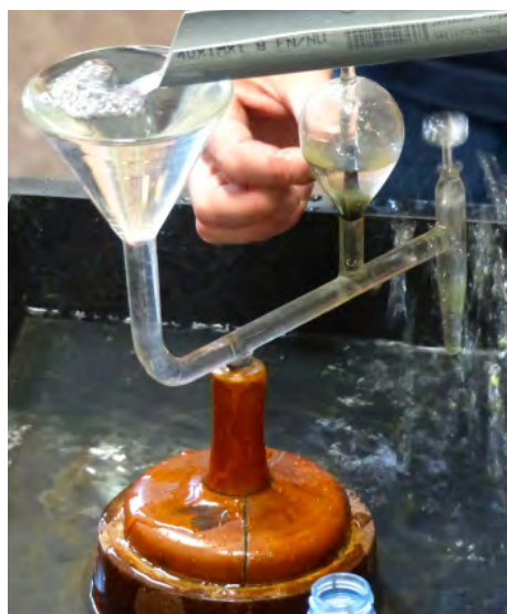
Yves Cornet fait fonctionner un bélière hydraulique (modèle de laboratoire). Ce type de pompe, installée sous la cour devant l'église, a permis aux élèves de profiter d'eau courante et douches dès 1890...
