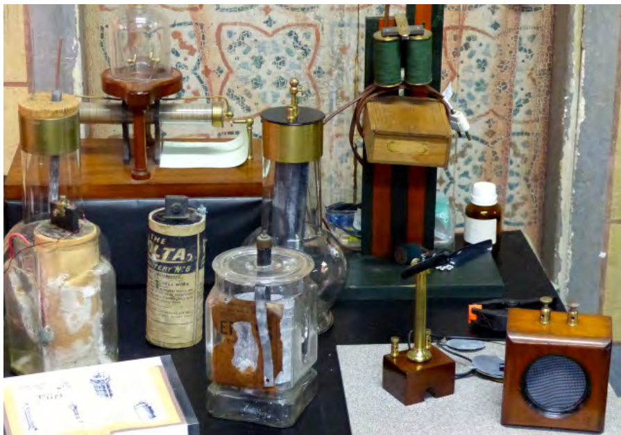
Des piles (Grenet, Leclanché) et la mise en évidence du courant fourni par une pile de Volta (alimentation d'un petit moteur et mise en mouvement d'une hélice ou activation d'un module musical).
