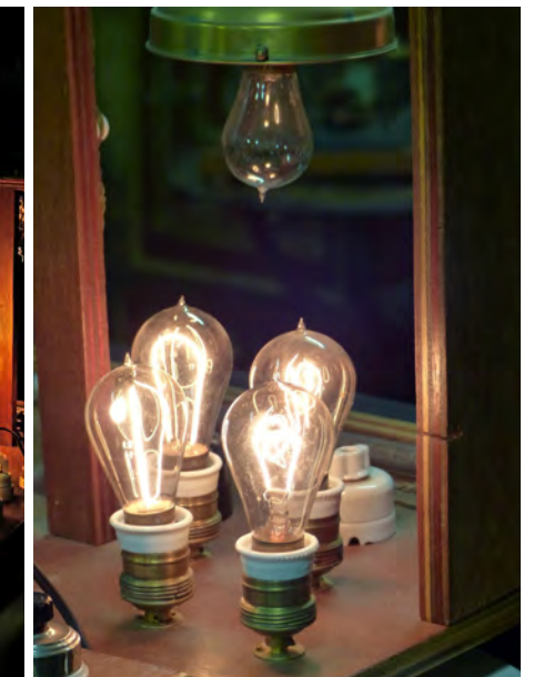
Une belle collection de lampes à incandescence à filament de carbone (type Edison) encore en état de marche.
