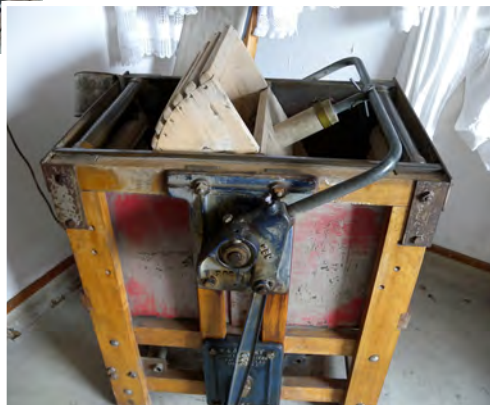
Machine à battre munie d'un moteur électrique (après 1930)
