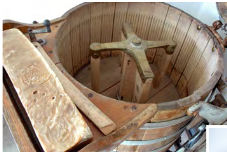
Tonneau à lessiver en bois avec mécanisme actionné par un engrenage après la guerre 1914-18.
