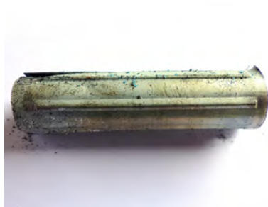
Feuille de zinc enroulée, à l'intérieur de la pile
