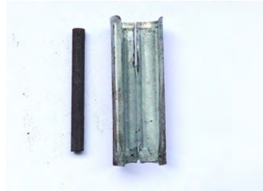
Bâton de carbone et feuille de zinc déployée
