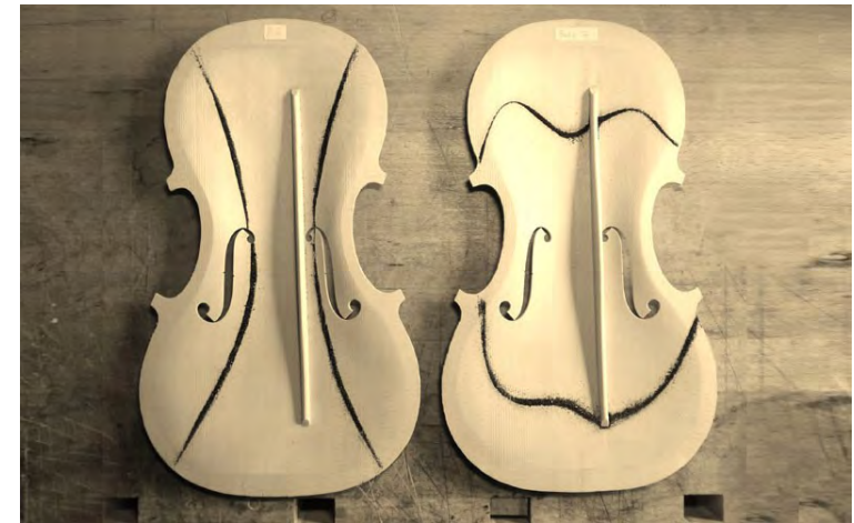
Figures de Chladni sur la table d'harmonie d'un violon ( www.mizzotti.at )
