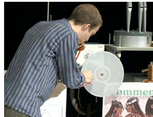
La sirène de Seebeck, en fonctionnement.
