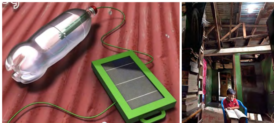
Le deuxième modèle « Liter of Light at Night » ajoute un panneau solaire et une ampoule led dans l'eau.
