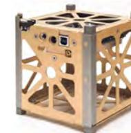
Structure de base d'un CubeSat.
