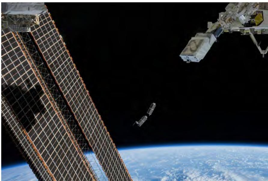
Deux nanosatellites de la constellation Flock-1 sont éjectés de la Station Spatiale Internationale (ISS) par le système de déploiement de NanoRacks, le 25 février 2014.
