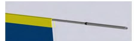
*Une sonde de Langmuir placée à l'extrémité d'un panneau solaire.*
