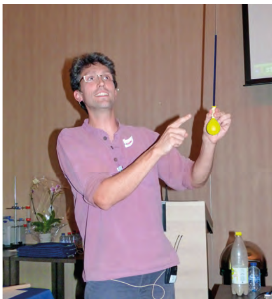
Fig. 7 : Un tube en verre est placé dans un ballon de baudruche qui est rempli de sable et d'eau colorée en bleu. Un petit bout de tissu ferme le tube en verre. Ceci permet l'échange d'eau mais empêche tout échange de sable entre le ballon et le tube. L'eau remplit tout le ballon ainsi qu'une partie du tube.
