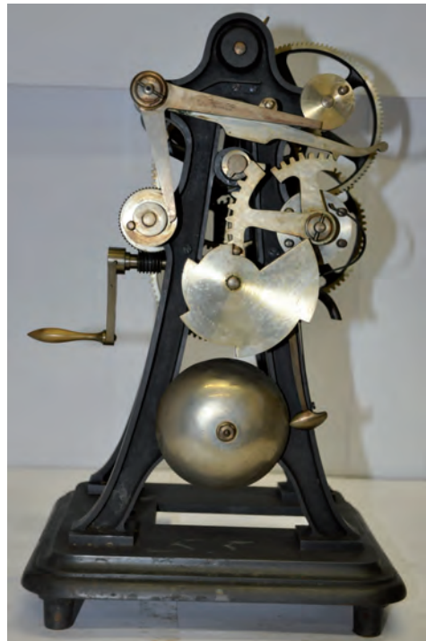
Modèle de mécanisme de sonnerie pour horloge anglaise, Gustav Voigt, Berlin (coll. Science & Culture)
