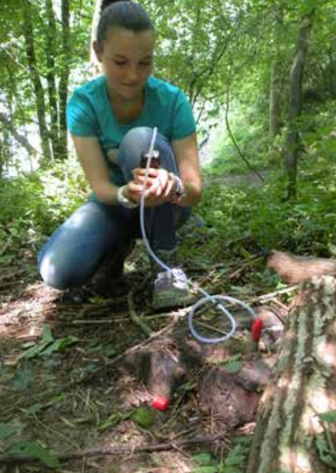
Mesure de CO_2 dans le sol
