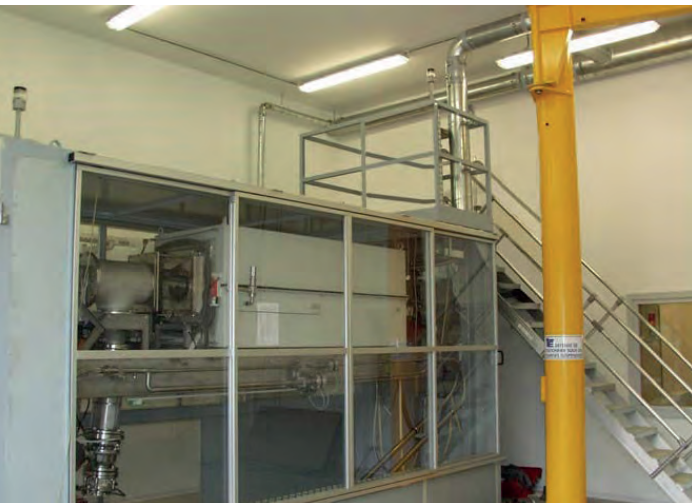
Figure 9 : Réacteur pilote de production de CNT de Nanocyl S.A.
