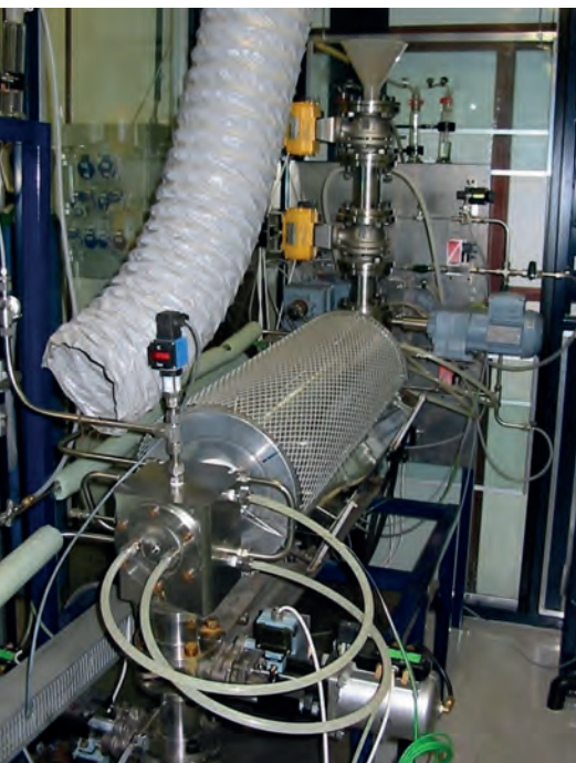
Figure 4 : Réacteur continu de production de CNT du Laboratoire de Génie chimique.
