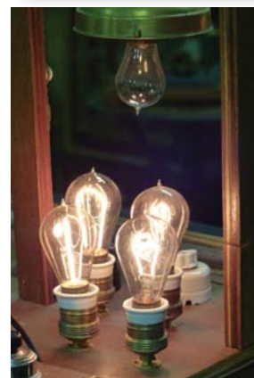
Lampes (65 volts) à filament de carbone au Musée des Instruments Scientifiques de l'Institut Saint-Roch à Theux, p. 86
