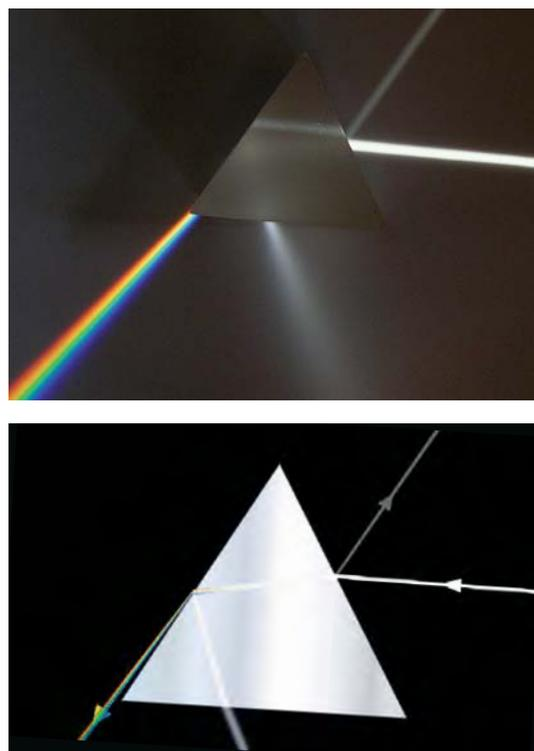
Fig. 1. Lorsque de la lumière blanche passe à travers un prisme, on observe, à la sortie, tout un spectre de couleurs qui rappelle l'arc-en-ciel. La réfraction provoque la dispersion de la lumière. On notera également les deux réflexions du faisceau lumineux sur les interfaces air/verre et verre/air.
