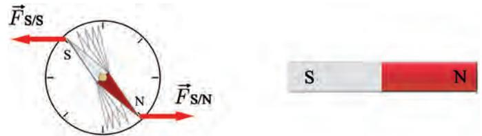
Fig. 1 : Les forces exercées par un aimant sur les pôles d'une boussole font pivoter l'aiguille.
